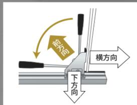
左右の特殊固定金具のレバーを倒すだけで止水パネルを柱と床に圧着。素早く、しっかり固定できます。
