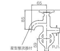
ひとつは万能パイプになっており、パイプが360度回転します。星型整流器付きで、水はねが抑えられます。もう片方はワンタッチニップルがついており、散水ホースを簡単に取付け可能。ワンタッチニップルは取外しができるので、シャワーホースもつけられます。
