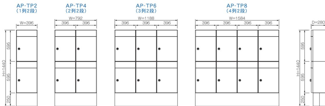
■規格寸法図(mm)
