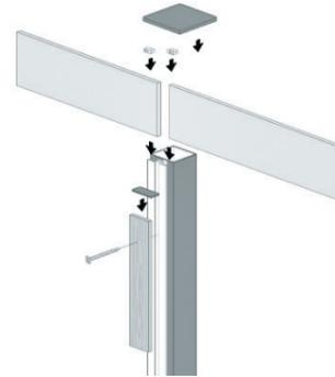
ビスの使用を極力少なくした、「Tバー方式」。フェンス板と同じ材の「縦材」で化粧をしますので、スッキリした印象に仕上がります。
