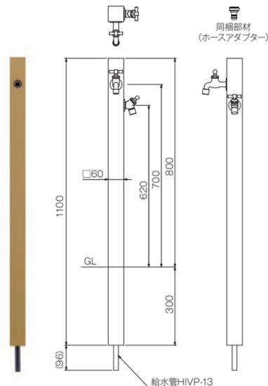
⚠ 寒冷地の場合、水栓柱または凍結防止ソケットを設置していただく必要があります。
