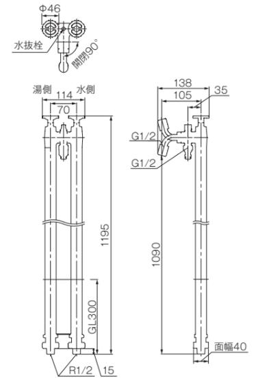
配管接続部がユニオンナット方式になっている為、配管途中に付けるエルボの位置決めが簡単にでき、施工時間を短縮出来ます。
