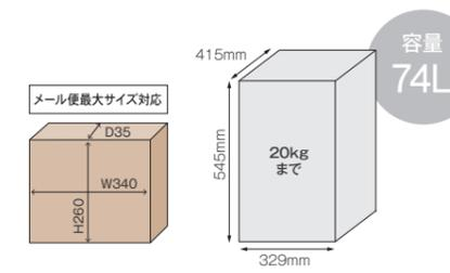
■ 規格寸法図(mm)
